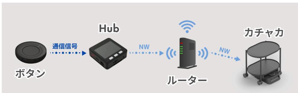
カチャカボタンHubを中継器とし、カチャカボタンが押されたことを通信信号により認識し、ネットワークを経由してカチャカに指示を実行します。カチャカボタンのご利用には中継器となるカチャカボタンHubとルーター等のネットワーク環境が必要となります。2-5に従ってカチャカボタンHubとカチャカボタンの設定をして下さい。カチャカボタンHubは複数のカチャカボタンを登録することが可能です。
