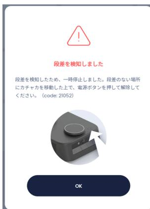
カチャカが動く範囲に段差、階段などが無い場合には段差検知をOFFに設定してください。段差や階段がある場合は、黒いマットの範囲に進入禁止エリアを追加してください。
